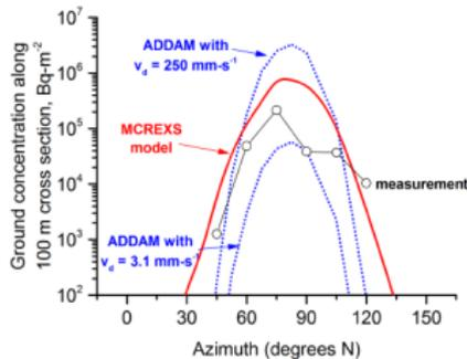
(d) Azimuthal cross-section of deposition profile at 100 m
